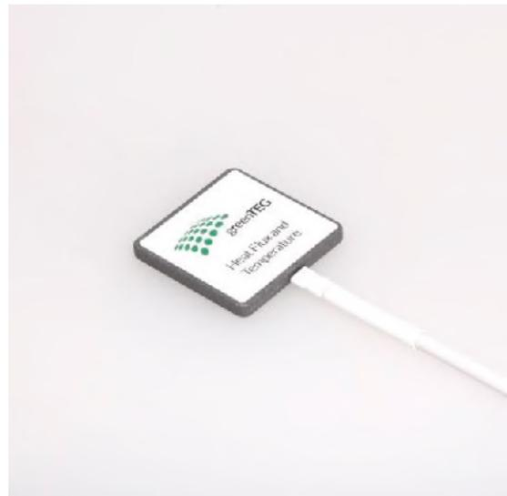
(d) Combined heat flux and surface temperature sensor
